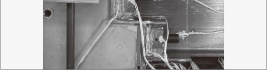
提案した梁端接合部の載荷実験の様子
